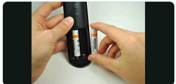
Las baterías van en la parte posterior del control
